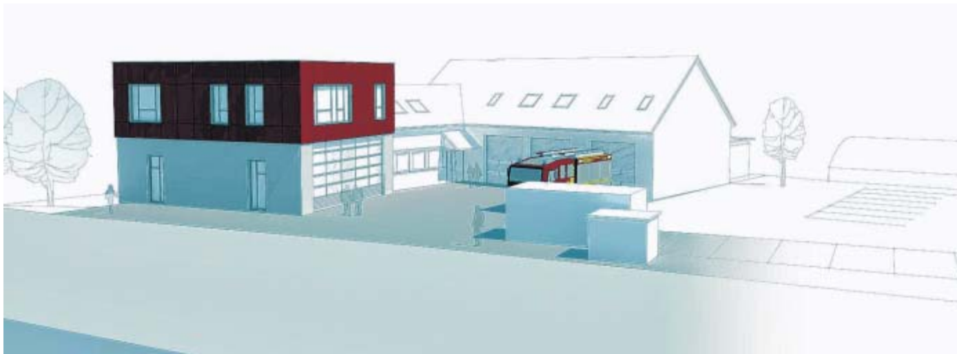
Die erste Planungskizze: So könnte das Feuerwehrgerätehaus in Schweicheln an der Herforder Straße nach dem Umbau aussehen. Der rote Baukörper ist leicht verschwenkt und dient als Halle für Großfahrzeuge. Schulungsräume würden im Obergeschoss untergebracht. SKIZZEN: BAHR
